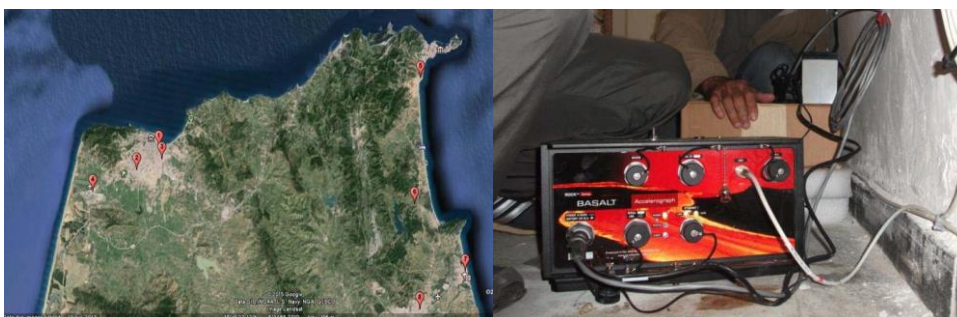
Répartition des nouvelles stations accélérographes dans la péninsule tangéroise Type d'équipement installé : Accélérographe modèle Basalt.
